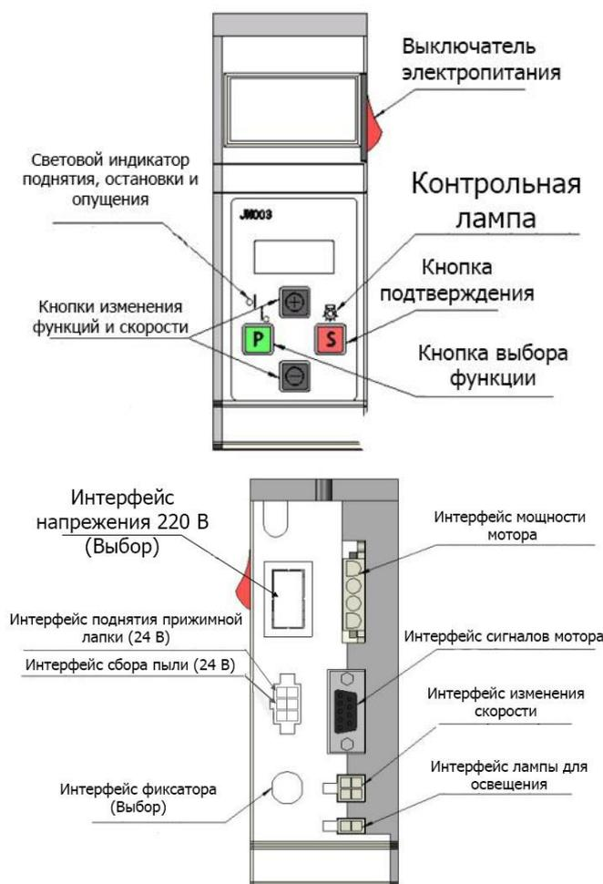
Эта система управления отражает передовую концепцию проектирования, она проста в использовании. Вся система управления имеет превосходную производительность. Продукт обладает такими достоинствами, как точность, быстрый старт и остановка. Кроме того, он имеет превосходные защитные функции модуля электрической цепи: защита от слишком низкого или слишком высокого напряжения. Контроллер скорости может осуществлять бесступенчатое регулирование скорости.
